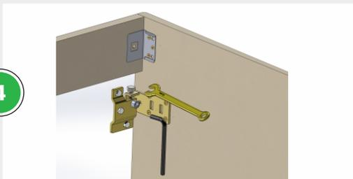
Utilice un destornillador para regular el nivel y la distancia del mueble a la pared, ajustando o desajustando (según necesidad) los tornillos de los colgadores.
