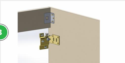
Cuelgue el mueble -utilizando los colgadores ya instalados en el mismo- en las placas metálicas ya amuradas a la pared.
