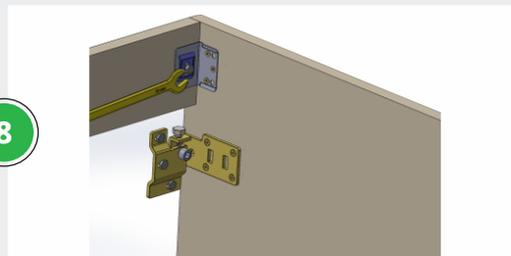
Atornille el mueble a la pared, pasando los dos (2) tornillos tirafondos (5 x 70) por el clip -colocarlos- y fijando firmemente desde las escuadras de refuerzo.
