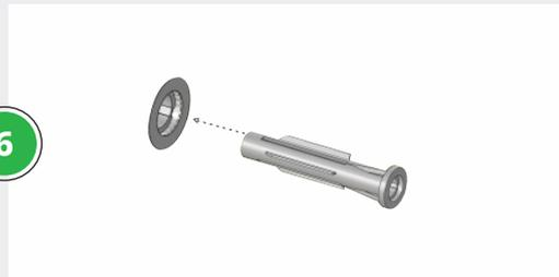
En las marcas realizadas en la pared, coloque los tarugos (2). Sepa que allí se sujetará el mueble desde las escuadras de refuerzo.
